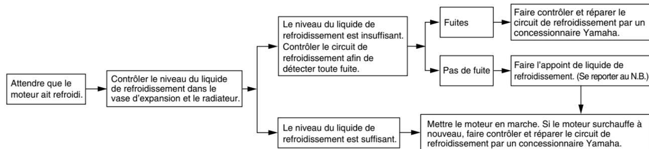
**N.B.** Si le liquide de refroidissement recommandé n'est pas disponible, on peut utiliser de l'eau du robinet, à condition de la remplacer dès que possible par le liquide prescrit.
