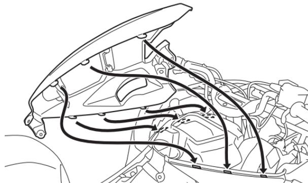
2. Poser les vis, les rivets démontables, les boulons et les durites.
