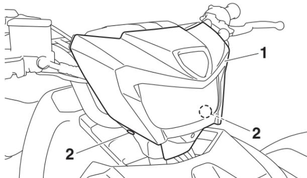
1. Protection du phare monté sur le guidon
