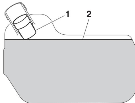
1. Tube de remplissage du réservoir de carburant
