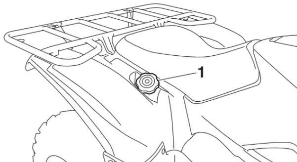
1. Bouchon du réservoir de carburant
