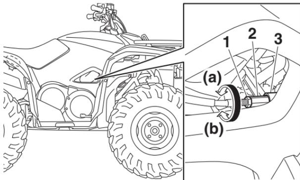
1. Contre-écrou du dispositif de réglage du câble de frein
