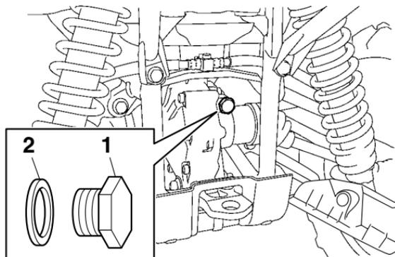
1. Bouchon de remplissage de l'huile de couple conique arrière
