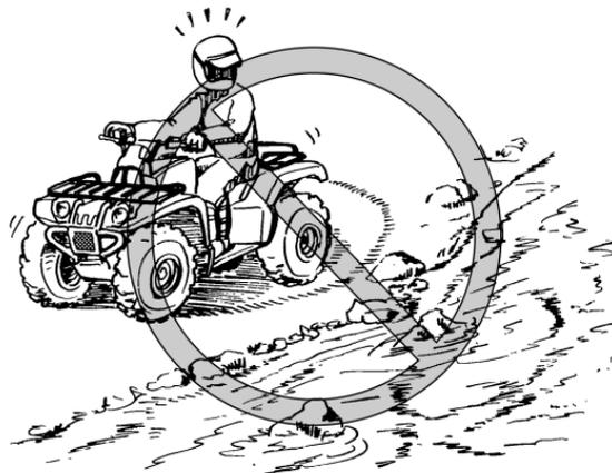
Essayer les freins après avoir roulé dans de l'eau. Si nécessaire, les actionner plusieurs fois pour que le frottement sèche les garnitures. Ne pas conduire le VTT avant de s'être assuré que les freins fonctionnent correctement.
