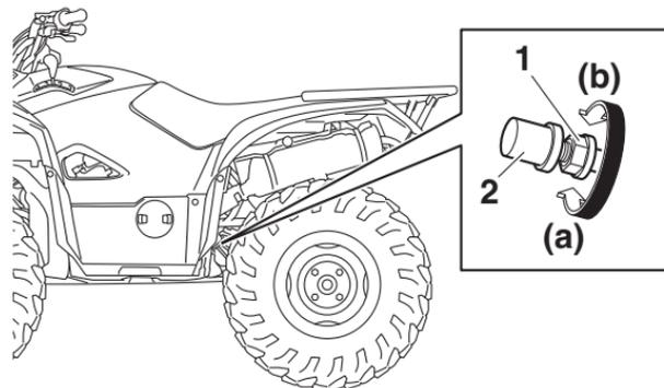
1. Écrou de réglage du contacteur de feu stop sur frein arrière
