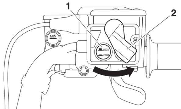
1. Commutateur du système d'entraînement On-Command “4WD/LOCK”
