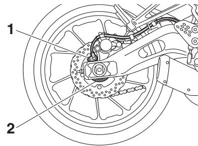
1. Capteur de roue arrière
