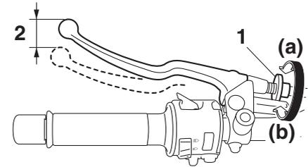
1. Vis de réglage de la garde du levier d'embrayage
