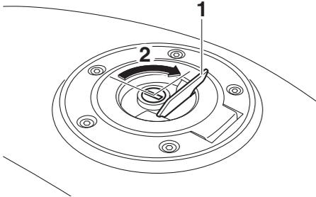
1. Cache-serrure du bouchon de réservoir de carburant
