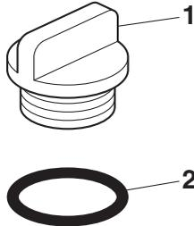
1. Bouchon de remplissage de l'huile moteur
