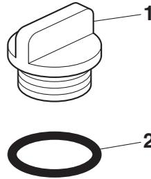
1. Bouchon de remplissage de l'huile moteur
