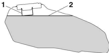
1. Tube de remplissage du réservoir de carburant
