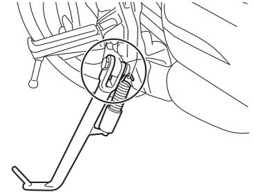
Contrôler le fonctionnement de la béquille latérale avant chaque départ et lubrifier son articulation et les points de contact des surfaces métalliques quand nécessaire.
