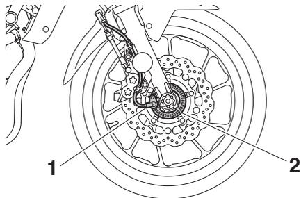
1. Capteur de roue avant
