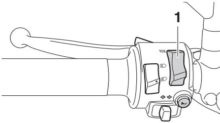
1. Contacteur du système de régulation antipatinage "TCS"
