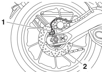
1. Capteur de roue arrière
