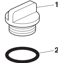
1. Bouchon de remplissage de l'huile moteur
