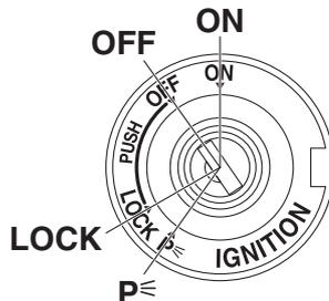
Le contacteur à clé/antivol commande les circuits d'allumage et d'éclairage et permet de bloquer la direction. Ses diverses positions sont décrites ci-après.
