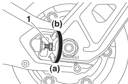
1. Vis de réglage de la tension de la chaîne de transmission
