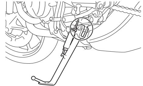
Contrôler le fonctionnement de la béquille latérale avant chaque départ et lubrifier son articulation et les points de contact des surfaces métalliques quand nécessaire.
