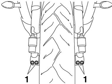
1. Vis de pincement d'axe de roue avant
