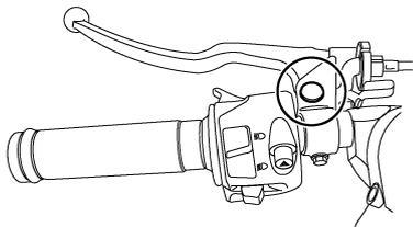
Contrôler le fonctionnement des leviers de frein et d'embrayage avant chaque départ et lubrifier les articulations de levier quand nécessaire.
