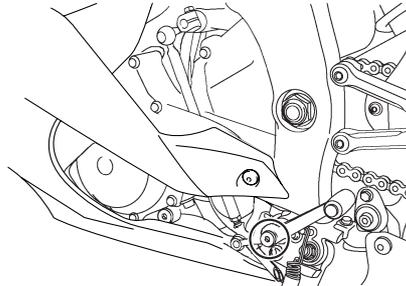
Contrôler le fonctionnement de la pédale de frein et du sélecteur avant chaque départ et lubrifier les articulations quand nécessaire.
