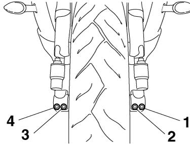
1. Vis de pincement A d'axe de roue avant
