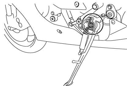
Contrôler le fonctionnement de la béquille latérale avant chaque départ et lubrifier son articulation et les points de contact des surfaces métalliques quand nécessaire.
