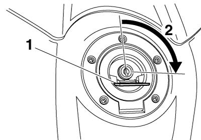
1. Cache-serrure du bouchon de réservoir de carburant
