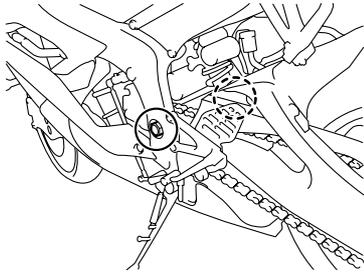
Faire contrôler les pivots du bras oscillant par un bras oscillant aux fréquences spécifiées dans le tableau des entretiens et graissages périodiques.
