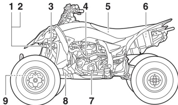
9. Vis de réglage de la force d'amortissement à la détente de combiné ressort-amortisseur avant
