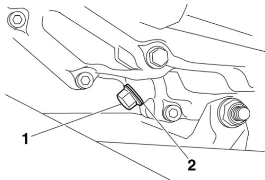
1. Vis de vidange du réservoir d'huile moteur
