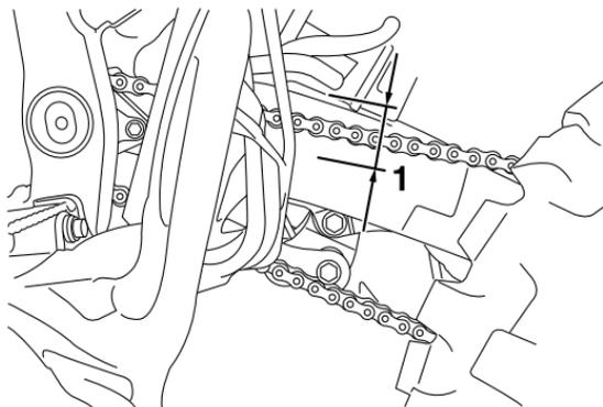
1. Tension de la chaîne de transmission
