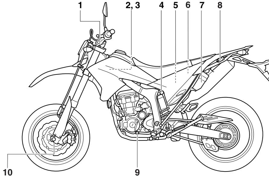
1. Vis de réglage de la force d'amortissement à la détente de la fourche (page 3-14)
