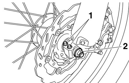
1. Vis de pincement d'axe de roue avant
