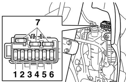
1. Fusible du système d'injection de carburant
