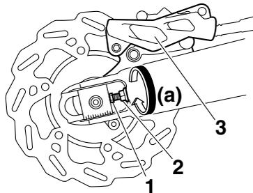
1. Vis de réglage de la tension de la chaîne de transmission
