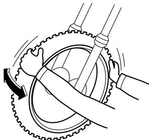
Contrôler les roulements de roue avant et arrière aux fréquences spécifiées dans le tableau des entretiens et graissages périodiques. Si le moyeu de roue a du jeu ou si la roue ne tourne pas régulièrement, faire contrôler les roulements de roue par un concessionnaire Yamaha.
