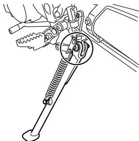
Contrôler le fonctionnement de la béquille latérale avant chaque départ et lubrifier son articulation et les points de contact des surfaces métalliques quand nécessaire.
