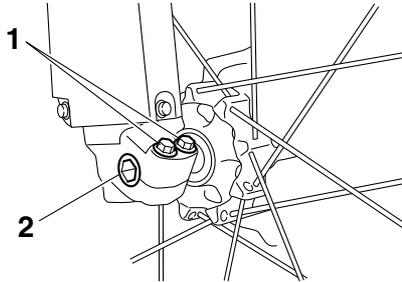
1. Vis de pincement d'axe de roue avant
