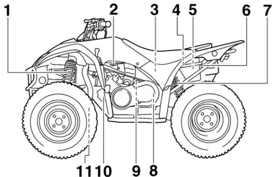
11. Tube de vidange du conduit de refroidissement de la courroie trapézoïdale
