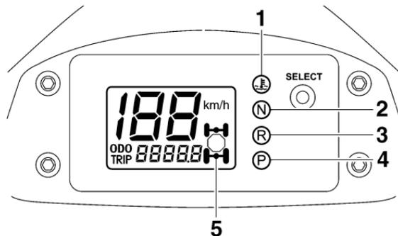
1. Témoin d'alerte de la température du liquide de refroidissement “
