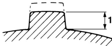
1. Limite d'usure de pneu
