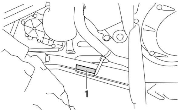
1. Numéro d'identification du véhicule (côté avant gauche)
