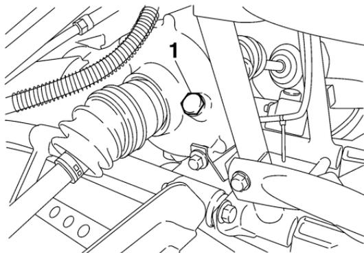
1. Bouchon de remplissage de l'huile de différentiel
