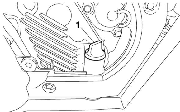
1. Bouchon de remplissage de l'huile moteur
