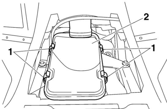
1. Attache du couvercle du boîtier de filtre à air
