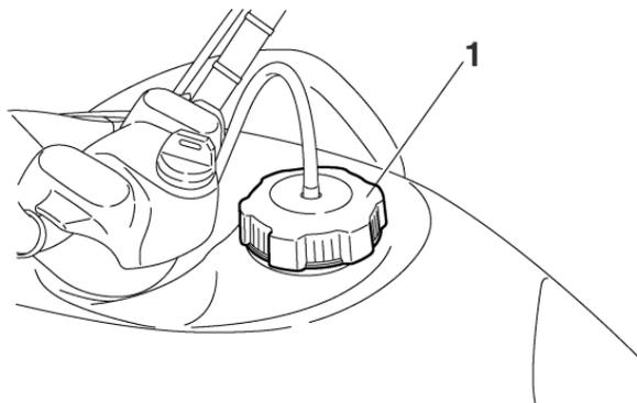
1. Bouchon du réservoir de carburant
