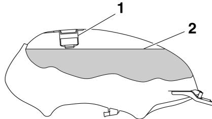
1. Tube de remplissage du réservoir de carburant
