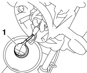
1. Protection de douille d'ampoule de phare
