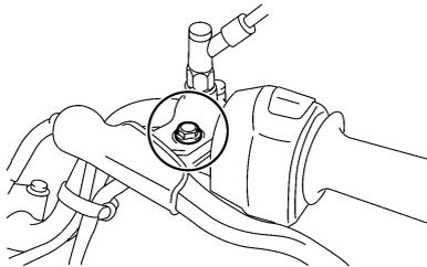
Contrôler le fonctionnement du levier de frein et d'embrayage avant chaque départ et lubrifier les articulations de levier quand nécessaire.
