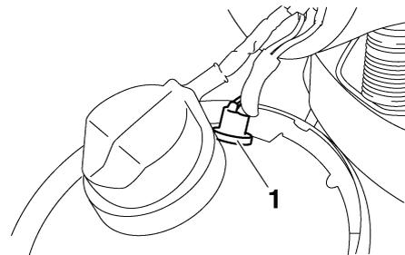
1. Douille d'ampoule de veilleuse
