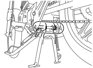
Contrôler le fonctionnement des béquilles centrale et latérale avant chaque départ et lubrifier les articulations et les points de contact des surfaces métalliques quand nécessaire.
