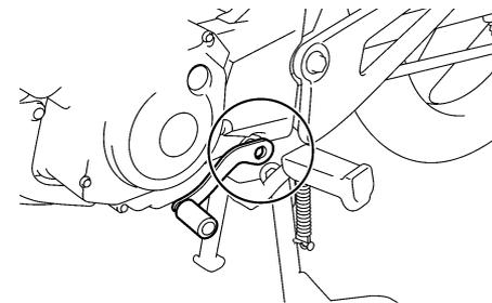
Contrôler le fonctionnement de la pédale de frein et du sélecteur avant chaque départ et lubrifier les articulations quand nécessaire.
