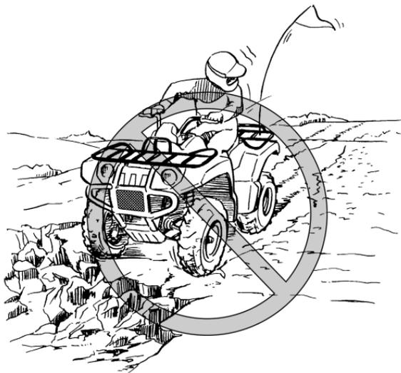
Ne jamais rouler sur un terrain rocailleux, glissant ou meuble, à moins d'avoir acquis les techniques nécessaires au contrôle du VTT sur ce genre de terrain. Toujours rester très vigilant sur ces types de terrain. **AVERTISSEMENT ! Le manque de prudence en cas d'utilisation sur un terrain excessivement rocailleux, glissant ou meuble risque d'entraîner la perte de traction ou de contrôle du véhicule, ce qui pourrait causer un accident ou un capotage.** [FWB01541]
