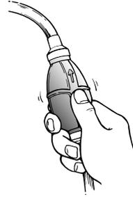
4. Ouvrez légèrement les gaz en restant au point mort à l'aide de la poignée d'accélérateur ou de l'accélérateur au point mort. Il est nécessaire de modifier légèrement l'ouverture des gaz en fonction de la température du moteur. Dès que le moteur a démarré, ramenez l'accélérateur sur sa position initiale.
