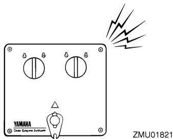
Lorsque le système d'avertissement est activé, arrêtez le moteur et vérifiez si l'entrée d'eau de refroidissement n'est pas obstruée.
