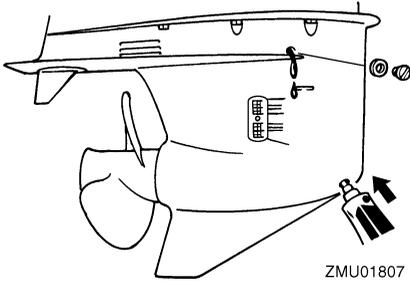
6. Lorsque l'huile commence à s'écouler par l'orifice de la vis de niveau d'huile, insérez et serrez la vis de niveau d'huile.
