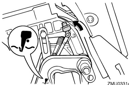
2. Relevez légèrement le moteur jusqu'à ce que la barre de support de relevage se dégage automatiquement.
