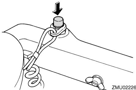
2. Après avoir arrêté le moteur, serrez la vis de mise à pression atmosphérique sur le bouchon du réservoir de carburant et placez le levier ou le bouton du robinet de carburant sur la position fermée, si équipé.
