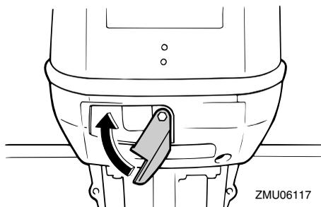
Après l'installation, vérifiez l'ajustement du capot supérieur en appuyant dessus des deux mains. Si le capot supérieur bouge, faites-le réparer par votre revendeur Yamaha.
