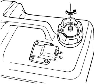
2. Si le moteur est équipé d'un raccord de carburant, raccordez fermement la conduite d'alimentation au raccord. Raccordez ensuite fermement l'autre extrémité de la conduite d'alimentation au raccord du réservoir de carburant.
