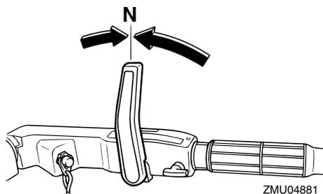
2. Placez le levier de verrouillage du système de relevage en position déverrouillée/relevée.
