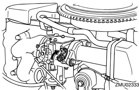
7. Insérez l'extrémité nouée de la corde de lancement de secours dans l'encoche du rotor du volant et enroulez la corde de plusieurs tours dans le sens horaire autour du volant.
