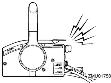
Lorsque le système d'avertissement est activé, arrêtez le moteur et vérifiez si l'entrée d'eau de refroidissement n'est pas obstruée.
