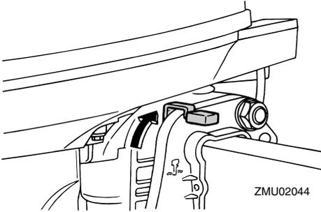
3. Relevez légèrement le moteur hors-bord. La barre de support de relevage se verrouille automatiquement, soutenant ainsi le moteur hors-bord dans une position partiellement relevée.
