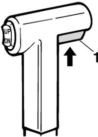
1. Commande de verrouillage de point mort
