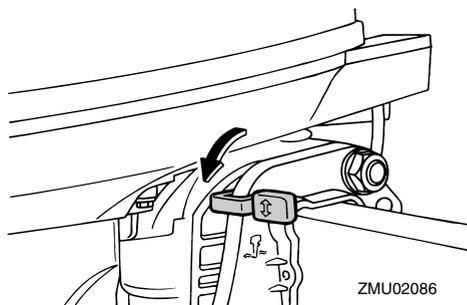
2. Relevez la commande de verrouillage au point mort (si équipé) et amenez le levier de commande à distance d'un geste ferme et rapide du point mort en marche arrière.
