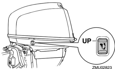
3. Pour ramener le moteur hors-bord à sa position de fonctionnement normale, appuyez sur l'interrupteur de trim et abaissez légèrement le moteur hors-bord.
