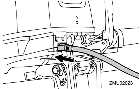
3. Si votre moteur hors-bord est équipé d'un dispositif de réglage de la friction de la direction, raccordez soigneusement la conduite d'alimentation à la fixation de la conduite d'alimentation.
