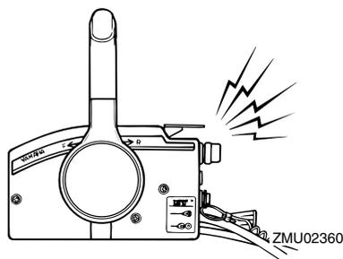
Si le système d'avertissement est activé, arrêtez le moteur aussi rapidement que votre sécurité le permet. Vérifiez le niveau d'huile et ajoutez de l'huile si nécessaire. Si le niveau d'huile est correct et que le dispositif d'avertissement ne s'arrête pas, consultez votre distributeur Yamaha.
