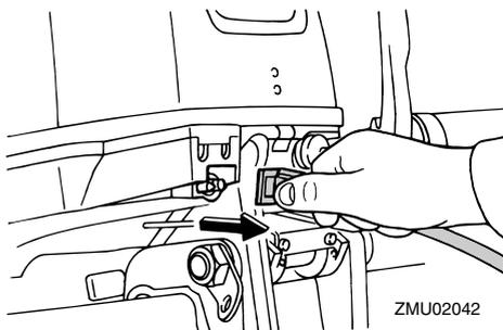
3. Serrez la vis de mise à pression atmosphérique sur le bouchon du réservoir de carburant (si équipé).
