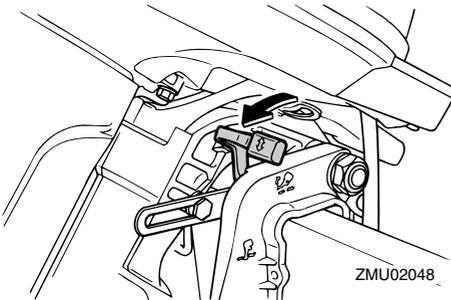
5. Relevez légèrement le moteur hors-bord jusqu'à ce que la barre de support de relevage revienne automatiquement en position libre.
