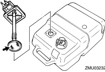
4. Nettoyez le filtre (situé à l'extrémité de la conduite d'aspiration) dans un solvant de nettoyage approprié. Laissez le filtre sécher.
