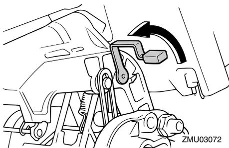
5. Relevez légèrement le moteur hors-bord jusqu'à ce que la barre de support de relevage revienne automatiquement en position libre.
