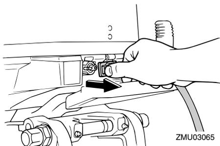
3. Placez le levier de verrouillage du système de relevage en position déverrouillée.
