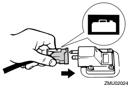
3. Si votre moteur hors-bord est équipé d'un dispositif de réglage de la friction de la direction, raccordez soigneusement la conduite d'alimentation à la fixation de la conduite d'alimentation.
