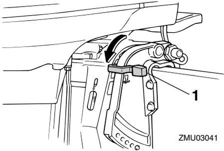
1. Levier de verrouillage du système de relevage
