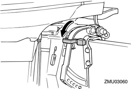
2. Relevez la commande de verrouillage au point mort (si équipé) et amenez le levier de commande à distance d'un geste ferme et rapide du point mort en marche arrière.
