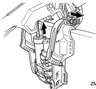
3. Appuyez sur l'interrupteur de trim "DN" (abaisser) pour abaisser le moteur hors-bord sur la position voulue.
