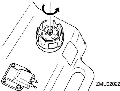
2. Si le moteur est équipé d'un raccord de carburant, raccordez fermement la conduite d'alimentation au raccord. Raccordez ensuite fermement l'autre extrémité
