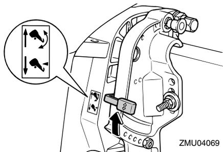
2. Maintenez l'arrière du capot supérieur d'une main, relevez légèrement le moteur hors-bord et tirez le bouton de support de relevage ou ramenez le levier de support de relevage.
