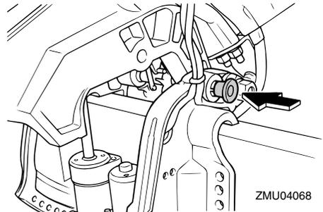
4. Modèles équipés de tiges de trim : Lorsque le moteur est soutenu par le levier support de relevage, appuyez sur l'interrupteur de trim "DN" (abaisser) pour rétracter les tiges de trim. **ATTENTION:** Veillez à rétracter complètement les tiges de trim lors de l'amarrage. Cela protège les tiges contre les concrétions marines et la corrosion qui pourraient endommager le mécanisme du système de trim. [FCM00251]
