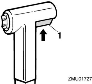
1. Commande de verrouillage de point mort
