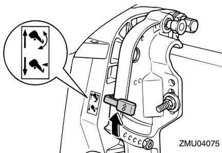
3. Relevez légèrement le moteur hors-bord jusqu'à la position voulue et abaissez le levier de verrouillage du système de relevage sur la position verrouillée.
