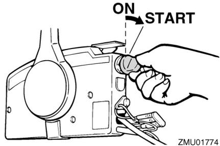
5. Dès que le moteur a démarré, relâchez l'interrupteur principal et laissez-le revenir sur la position "ON" (marche). **ATTENTION: Ne tournez jamais l'interrupteur principal sur la position "START" (démarrer) pendant que le moteur tourne. Ne laissez pas le moteur du démarreur tourner pendant**
