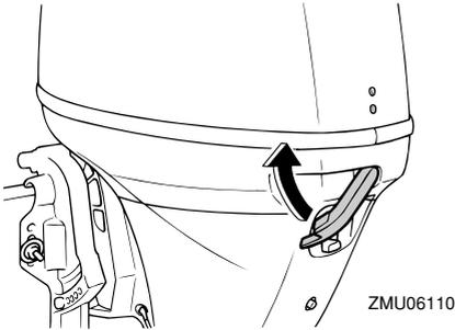
Après l'installation, vérifiez l'ajustement du capot supérieur en appuyant dessus des deux mains. Si le capot supérieur bouge, faites-le réparer par votre revendeur Yamaha.
