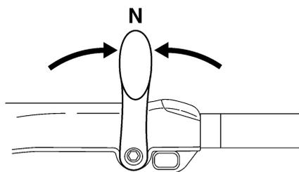
2. Relevez le levier de verrouillage du système de relevage sur la position déverrouillée.
