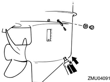
6. Placez un nouveau joint sur la vis de niveau d'huile. Lorsque l'huile commence à s'écouler par l'orifice de la vis de ni-
