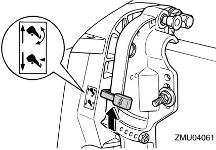
3. Maintenez l'arrière du capot supérieur d'une main et relevez le moteur suivant l'angle désiré.
