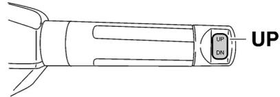
2. Relevez légèrement le moteur hors-bord jusqu'à la position voulue à l'aide de l'interrupteur de trim. **AVERTISSEMENT! L'utilisation de l'interrupteur de trim du capot inférieur en cours de navigation ou lorsque le moteur tourne accroît le risque de passer par-dessus bord et peut distraire l'opérateur, augmentant ainsi le risque de collision avec un autre bateau ou un obstacle.** [FWM01850]
