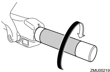
2. Lorsque le moteur tourne au ralenti en prise, amenez le levier de commande à distance / levier de changement de vitesses au point mort d'un geste ferme et vif.
