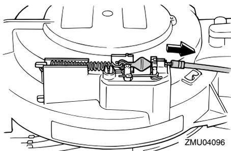
3. Déposez le couvercle du démarreur/volant après avoir retiré le(s) boulon(s).
