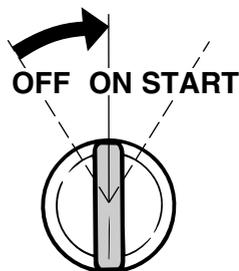
7. Préparez le moteur pour le démarrage. Pour plus d'informations, voir page 44. Assurez-vous que le levier de changement de vitesses est au point mort et que l'agrafe est attachée au coupe-circuit du moteur. L'interrupteur principal doit être sur la position "ON" (marche), si équipé.
