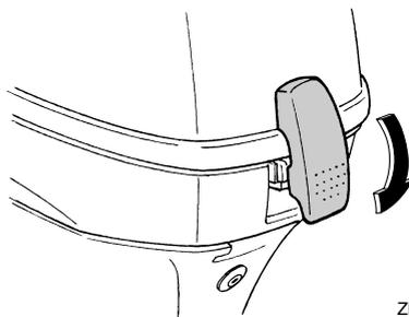
Après l'installation, vérifiez l'ajustement du capot supérieur en appuyant dessus des deux mains. Si le capot supérieur bouge, faites-le réparer par votre revendeur Yamaha.
