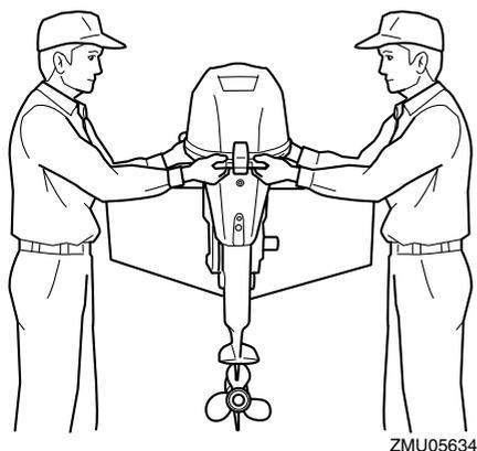
7. Lors du transport ou du remisage du moteur hors-bord après l'avoir démonté d'un bateau, maintenez le moteur hors-bord dans la position indiquée.
