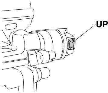
3. Enfoncez le bouton de support de relevage dans le support de fixation pour soutenir le moteur. **AVERTISSEMENT! Après avoir relevé le moteur, veillez à le soutenir au moyen du bouton support de relevage ou du levier support de relevage. Sinon, le moteur hors-bord risque de retomber brusquement si la pression d'huile dans le système de trim ou dans le système de relevage assisté venait à baisser.**
