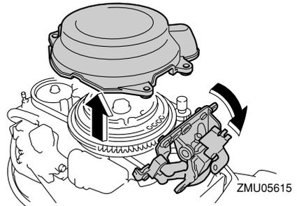
6. Fixez la plaque du système électrique en serrant le(s) boulon(s), et serrez la plaque.
