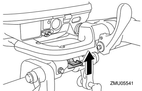
2. Relevez légèrement le moteur jusqu'à ce que la barre de support de relevage se dégage automatiquement.
