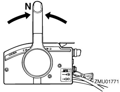
2. Relevez légèrement le moteur hors-bord jusqu'à la position voulue à l'aide de l'interrupteur du système de relevage assisté. **AVERTISSEMENT!** L'utilisation de l'interrupteur du système de relevage assisté, situé sur le capot inférieur en cours de navigation ou lorsque le moteur tourne, accroît le risque de passer par-dessus bord et peut distraire l'opérateur, augmentant ainsi le risque de collision avec un autre bateau ou un obstacle.
