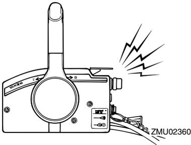
Si le système d'alerte est activé, arrêtez le moteur aussi rapidement que votre sécurité le permet. Vérifiez le niveau d'huile et ajoutez de l'huile si nécessaire. Si le niveau d'huile est correct et que le dispositif d'alerte ne s'arrête pas, consultez votre distributeur Yamaha.
