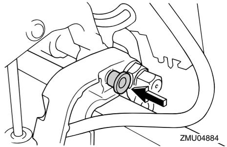
4. Modèles équipés de tiges de trim : Lorsque le moteur est soutenu par le levier support de relevage, appuyez sur l'interrupteur de trim "DN" (abaisser) pour rétracter les tiges de trim. **ATTENTION: Veillez à rétracter complètement les tiges de trim lors de l'amarrage. Cela protège les tiges contre les concrétions marines et la corrosion qui pourraient endommager le mécanisme du système de trim.** [FCM00251]
