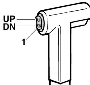
1. Interrupteur du système de relevage assisté
