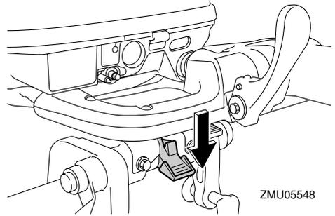
3. Relever légèrement le moteur hors-bord. La barre support de relevage se verrouille automatiquement, maintenant partiellement le moteur hors-bord en position de levage. Le moteur hors-bord possède 2 positions de croisière en eau peu profonde.
