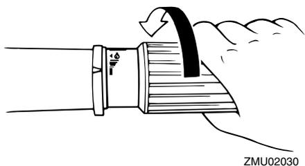
2. Lorsque le moteur tourne au ralenti en prise, amenez le levier de commande à distance / levier de changement de vitesses au point mort d'un geste ferme et vif.
