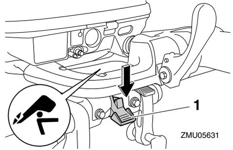
1. Levier de verrouillage du système de relevage (Déverrouillé / relevé)
