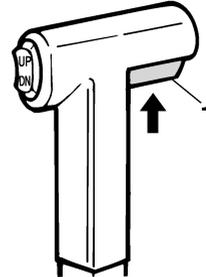
1. Commande de verrouillage de point mort
