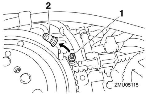
1. Soupape de mise à pression atmosphérique
