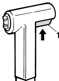
1. Commande de verrouillage de point mort
