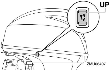
3. Enfoncez le bouton de support de relevage dans le support de fixation pour soutenir le moteur. **AVERTISSEMENT! Après avoir relevé le moteur, veillez à le soutenir au moyen du bouton support de relevage ou du levier support de relevage.** Sinon, le moteur hors-bord risque de retomber brusquement si la pression d'huile dans le système de trim ou dans le système de relevage assisté venait à baisser.
