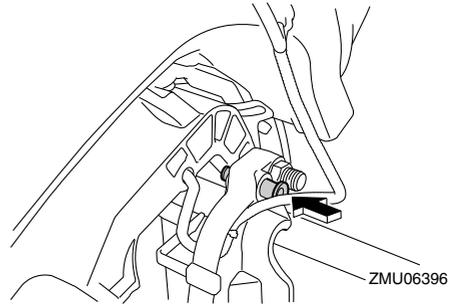
4. Modèles équipés de tiges de trim : Lorsque le moteur est soutenu par le levier support de relevage, appuyez sur l'interrupteur de trim "DN" (abaisser) pour rétracter les tiges de trim. **ATTENTION: Veillez à ce que les tiges de trim soient complètement rétractées lors de l'amarrage.** Cela protège les tiges contre les concrétions marines et la corrosion, qui pourraient endommager le mécanisme du système de trim.
