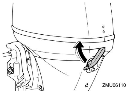
Après l'installation, vérifiez l'ajustement du capot supérieur en appuyant dessus des deux mains. Si le capot supérieur bouge, faites-le réparer par votre revendeur Yamaha.
