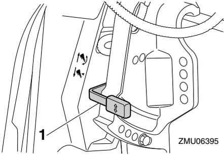
1. Levier de verrouillage du système de relevage
