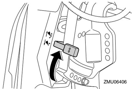
3. Maintenez l'arrière du capot supérieur d'une main, relevez le moteur et tournez le levier de support de relevage vers vous ou enfoncez le bouton support de relevage dans le support de fixation, puis ramenez le levier de verrouillage du système de relevage en position verrouillée pour soutenir le moteur hors-
