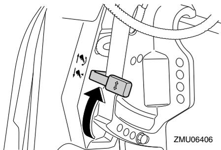
3. Relevez légèrement le moteur hors-bord jusqu'à la position voulue et abaissez le levier de verrouillage du système de relevage sur la position verrouillée.
