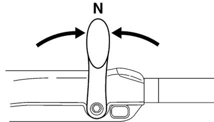
2. Placez le levier de verrouillage du système de relevage en position déverrouillée.
