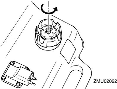
2. Si le moteur est équipé d'un raccord de carburant, alignez le raccord de carburant de la conduite d'alimentation sur le raccord de carburant du moteur et connectez fermement la conduite d'alimentation au raccord en pinçant le raccord. Raccordez ensuite fermement l'autre extrémité de la conduite d'alimentation au raccord du réservoir de carburant.
