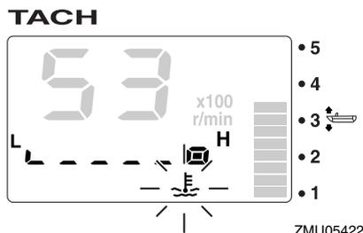
Arrêtez immédiatement le moteur si le vibreur retentit et si l'indicateur d'alerte de faible niveau d'huile clignote. Vérifiez la quantité d'huile moteur et faites l'appoint si nécessaire. Si le dispositif d'alerte est activé alors que la quantité d'huile appropriée est maintenue, consultez votre revendeur Yamaha.
