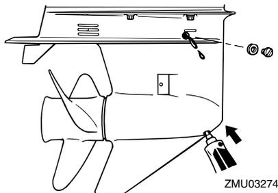
6. Placez un nouveau joint sur la vis de niveau d'huile. Lorsque l'huile commence à s'écouler par l'orifice de la vis de niveau d'huile, insérez et serrez la vis de niveau d'huile.
