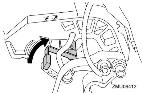
2. Maintenez l'arrière du capot supérieur d'une main, relevez légèrement le moteur hors-bord et tirez le bouton de support de relevage ou ramenez le levier de
