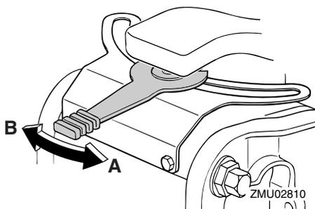
Si la résistance n'augmente pas même lorsque le levier est tourné vers bâbord "A", assurez-vous que l'écrou est serré au couple spécifié.
