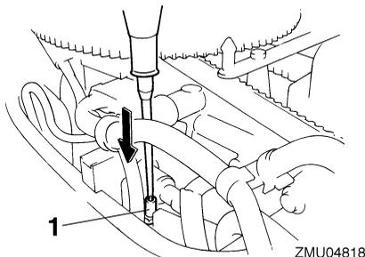
1. Soupape de mise à pression atmosphérique
