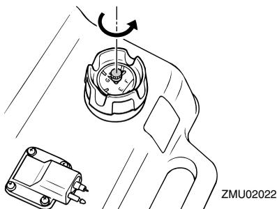
2. Si le moteur est équipé d'un raccord de carburant, raccordez fermement la conduite d'alimentation au raccord. Raccordez ensuite fermement l'autre extrémité de la conduite d'alimentation au raccord du réservoir de carburant.
