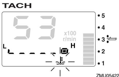
Arrêtez immédiatement le moteur si le vibreur retentit et si le dispositif d'avertissement de surchauffe a été activé. Vérifiez si l'entrée d'eau de refroidissement n'est pas obstruée.
