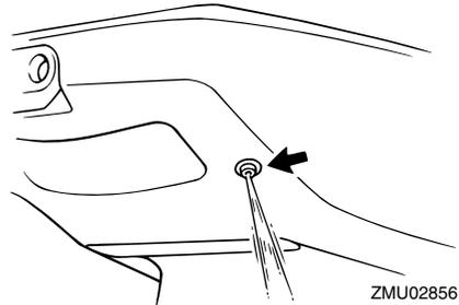
Vérifiez s'il n'y a pas de fuites d'eau au niveau des joints entre le couvercle d'échappement, la culasse et le bloc-cylindres.
