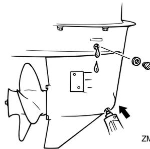
6. Placez un nouveau joint sur la vis de niveau d'huile. Lorsque l'huile commence à s'écouler par l'orifice de la vis de niveau d'huile, insérez et serrez la vis de niveau d'huile.
