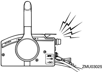
Lorsque le système d'alerte est activé, arrêtez le moteur et recherchez la cause.
