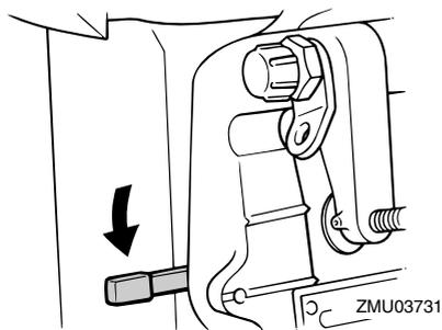
2. Relevez légèrement le moteur jusqu'à ce que la barre de support de relevage se dégage automatiquement.
