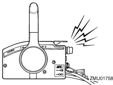
Lorsque le système d'alerte est activé, arrêtez le moteur et vérifiez si les entrées d'eau de refroidissement ne sont pas obstruées:
