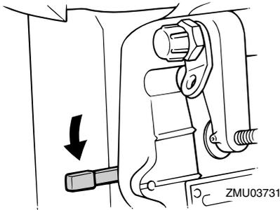
6. Relevez légèrement le moteur hors-bord jusqu'à ce que la barre de support de relevage revienne automatiquement en position libre.
