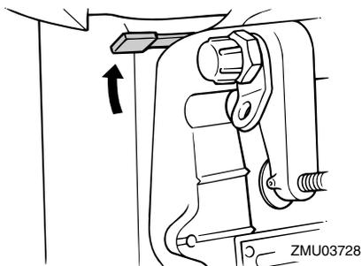
4. Relever légèrement le moteur hors-bord. La barre support de relevage se verrouille automatiquement, maintenant partiellement le moteur hors-bord en position de levage. Le moteur hors-bord possède 2 positions de croisière en eau peu profonde.
