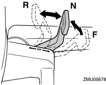
2. Lorsque le moteur tourne au ralenti en prise, amenez le levier de commande à distance / levier de changement de vitesses au point mort d'un geste ferme et vif.
