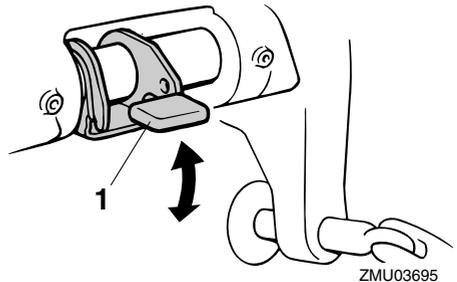
1. Levier de verrouillage du système de relevage
