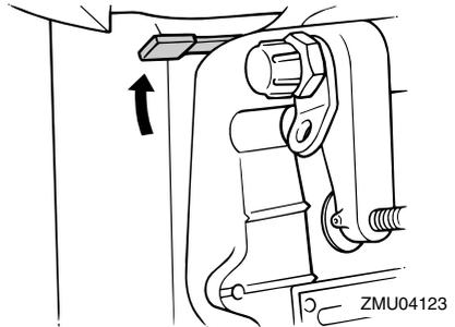
5. Maintenez l'arrière du capot supérieur d'une main et relevez complètement le moteur.
