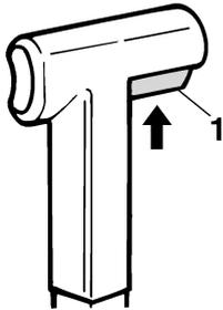
1. Commande de verrouillage de point mort
